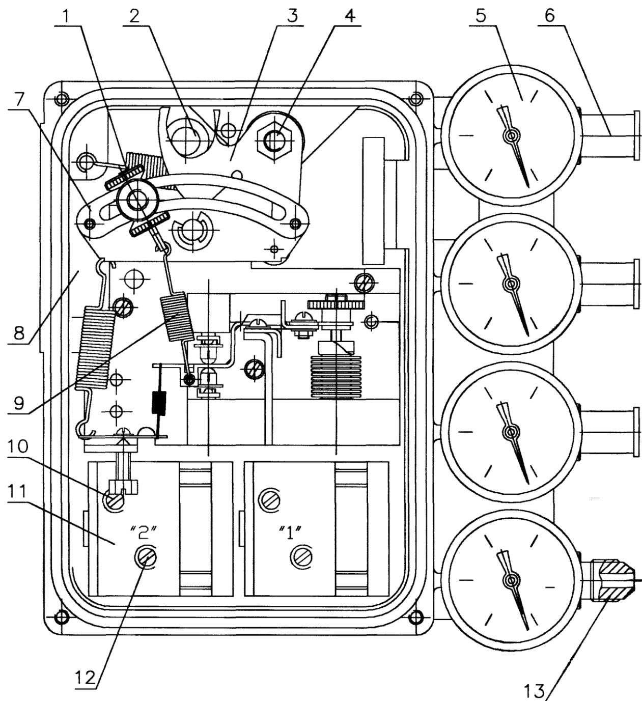
КОНСТРУКЦИЯ БЛОКА ПРЕОБРАЗОВАНИЯ
