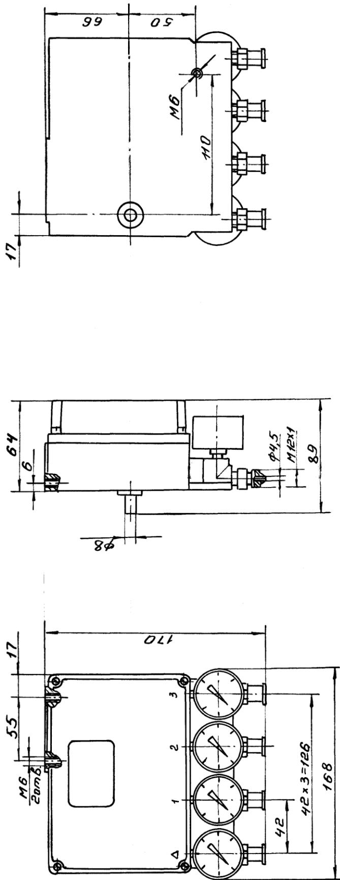
КОНСТРУКЦИЯ ПОЗИЦИОНЕРА ДВУСТОРОННЕГО ДЕЙСТВИЯ
