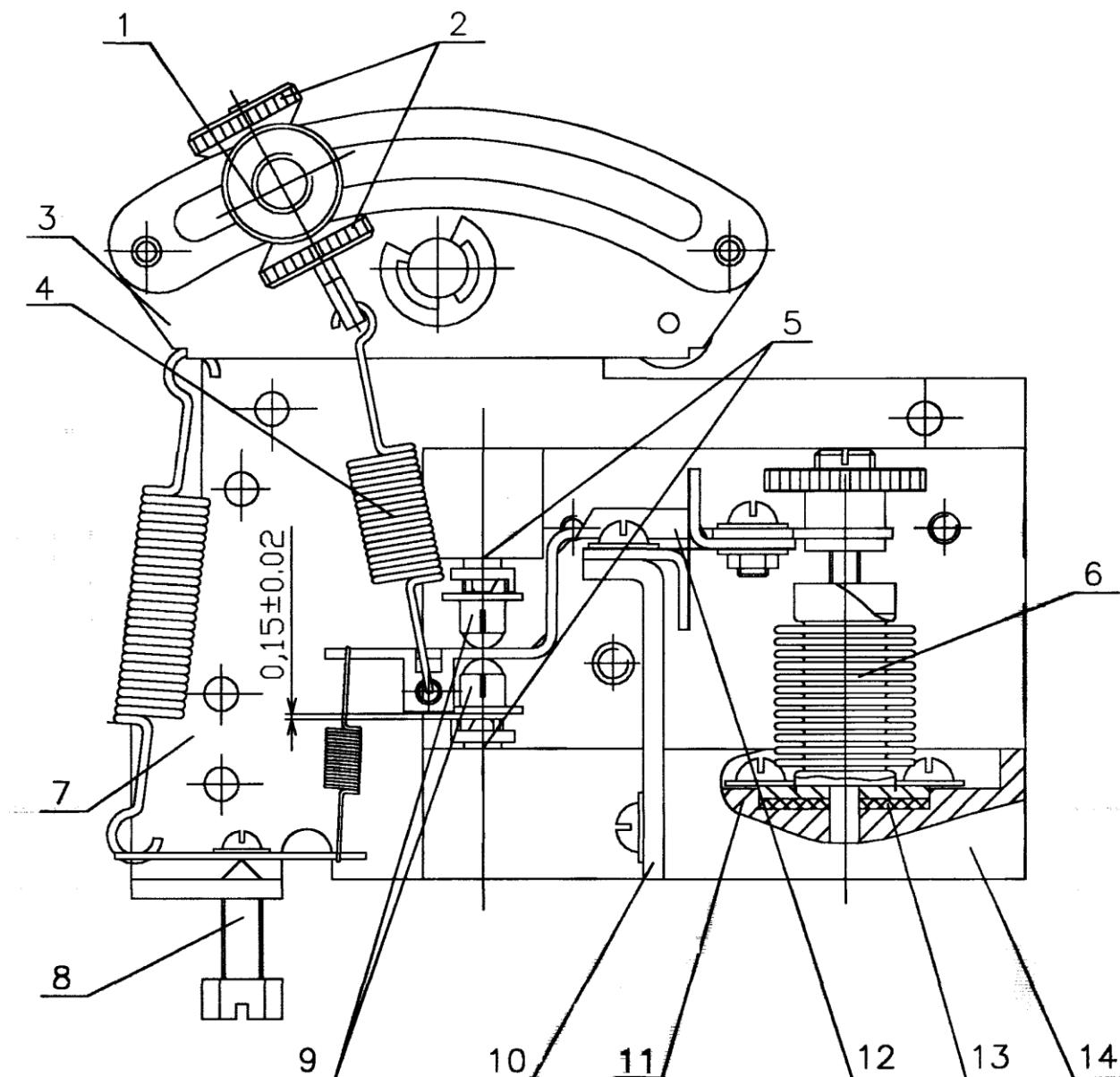
**ПРИНЦИПИАЛЬНАЯ СХЕМА ПНЕВМОПОЗИЦИОНЕРА
