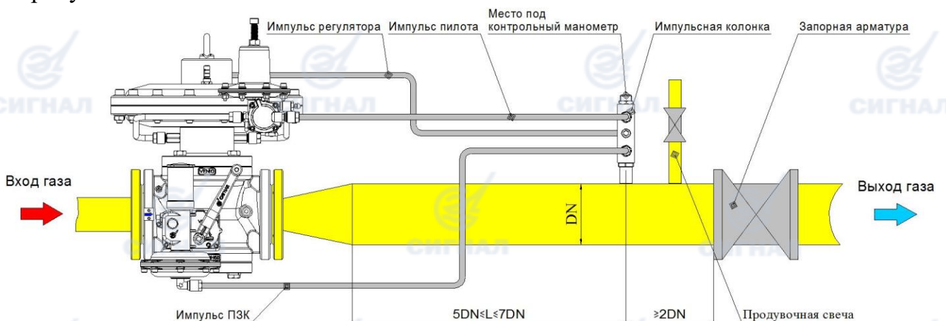
Рисунок 12. Схема установки регулятора VENIO-C.R5-Z-LR
