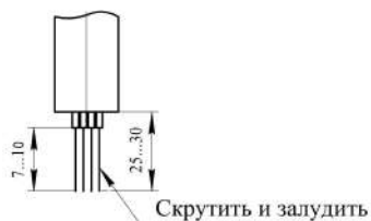
Подключение, заделка кабеля и уплотнение сальникового ввода
