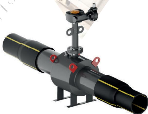
Полный проход | Цельносварной под приварку с присоединительными полиэтиленовыми патрубками с удлиненным шпинделем с покрытием усиленного типа с редуктором под Т-образный ключ 11с67п 3ЦПП.00(01).3
