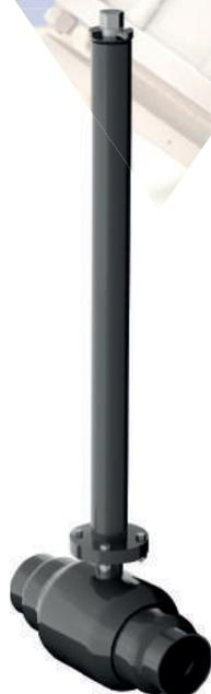
Полный проход | Цельносварной под приварку с удлиненным шпинделем с покрытием усиленного типа под Т-образный ключ
