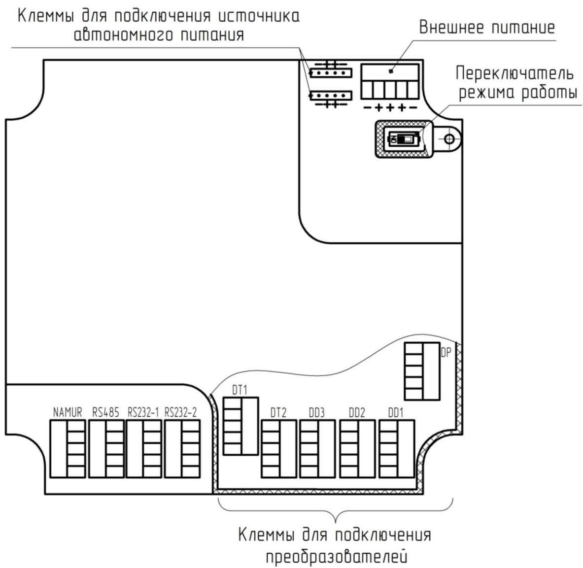
Рисунок Б1 - Расположение и маркировка клемм монтажной платы для подключения питания, преобразователей и внешних устройств
