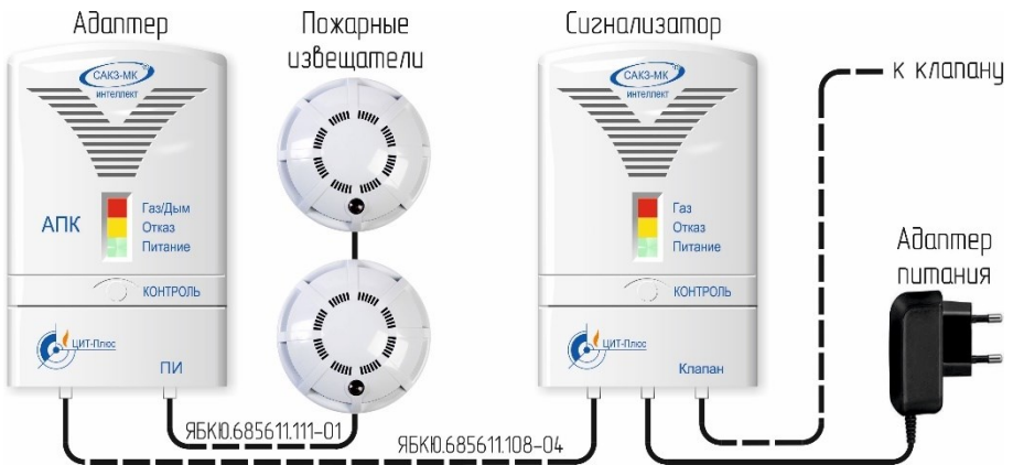
Рисунок В.2 – Типовая схема с клапаном и пожарными извещателями
