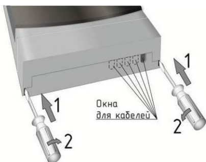
Рисунок 2 – Снятие крышки клеммного отсека
