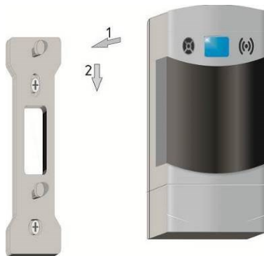
Рисунок Б.2 – Установка БСУ на монтажную панель
