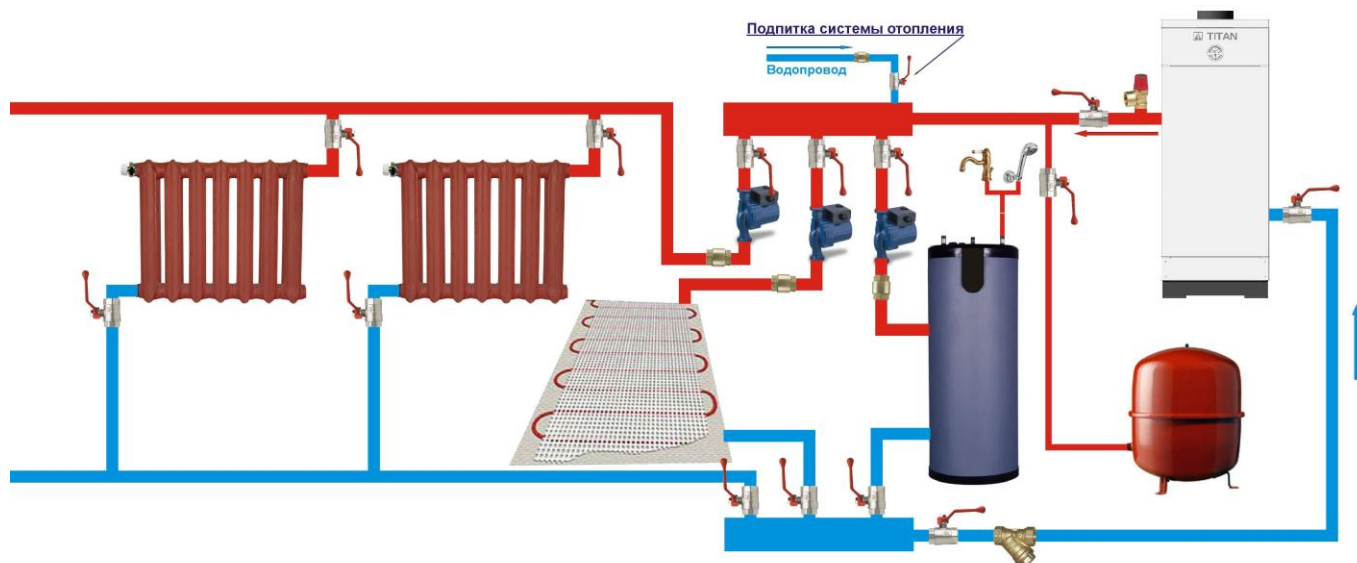
Рисунок 6. Схема подключения котла с общим коллектором
