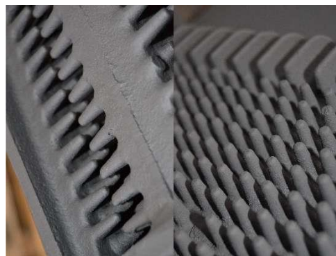
Рисунок 1. Внешний вид поверхностей теплообменника
