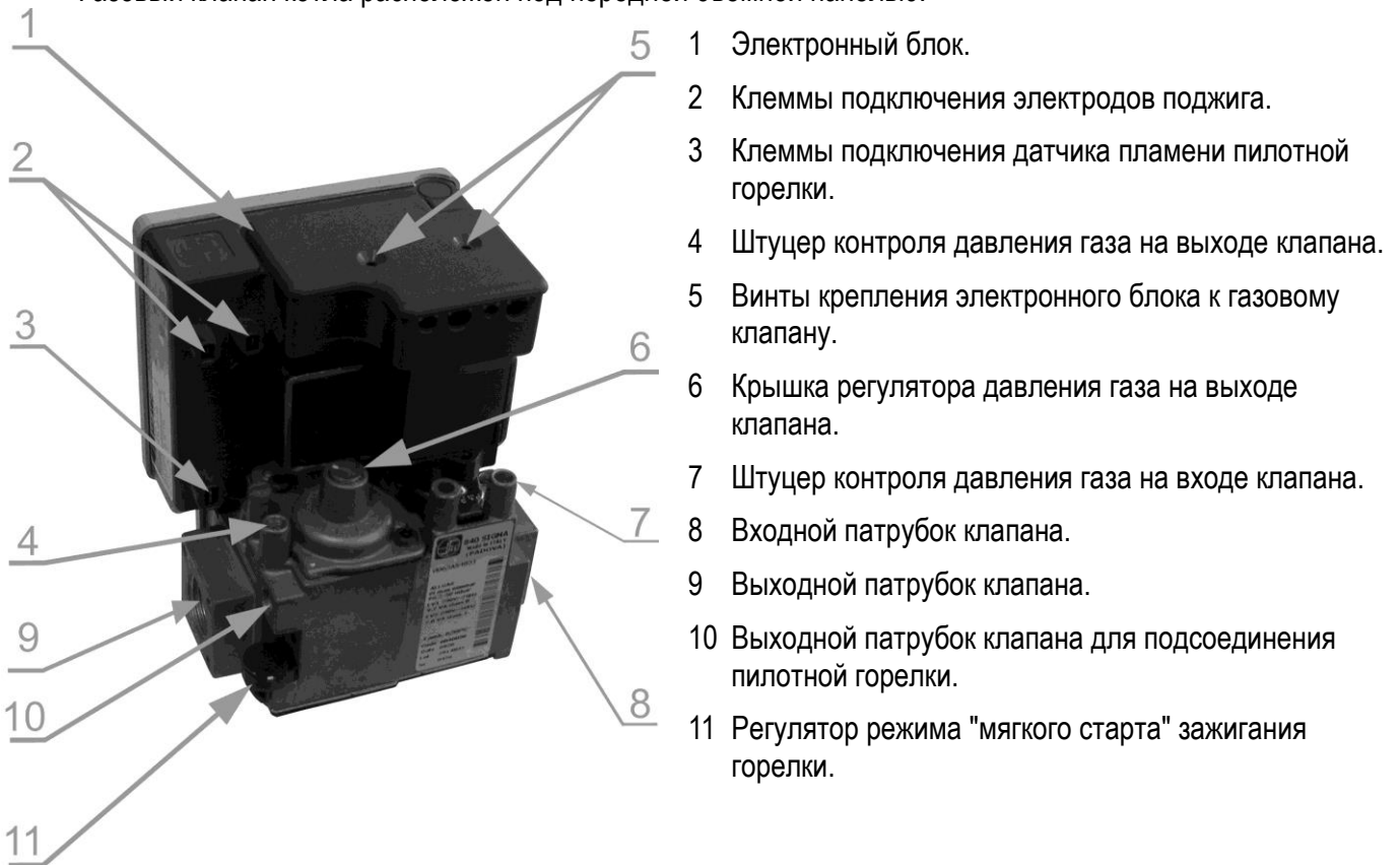
Рисунок 10. Газовый клапан котла с автоматикой.
