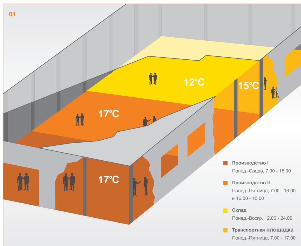
01 Частичный обогрев независимых отапливаемых зон внутри одного здания
