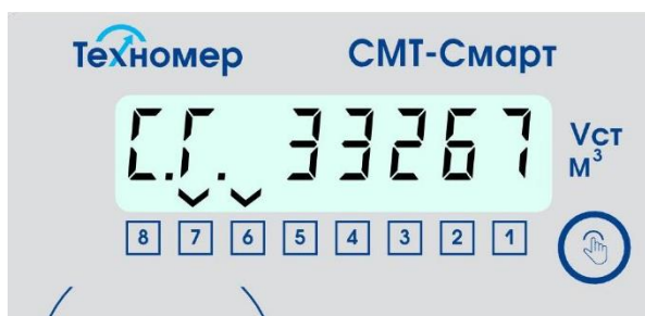
Рисунок 34 – индикация раздела «Состав газа» (К-фактор=33267-природный газ)
