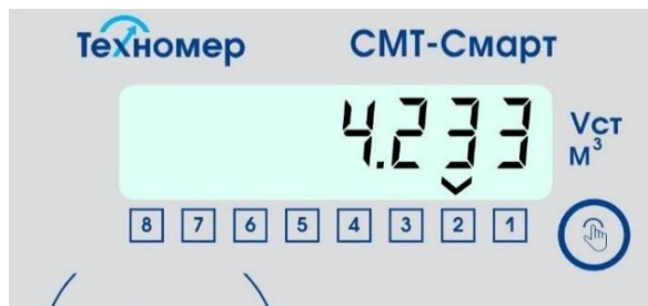
Рисунок 13 – индикация раздела «Мгновенный расход газа»
