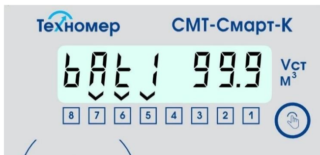
Рисунок 44 – Индикация раздела «Состояние резервной батареи счетчика»
