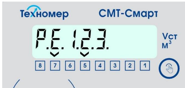
Рисунок 32 – индикация раздела «Регистр тревог» (зарегистрированы тревоги E1, E2, E3)
