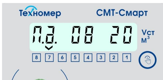
Рисунок 9 – Индикация активного сеанса связи
