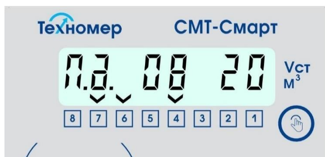
Рисунок 42 – Индикация активного сеанса связи
