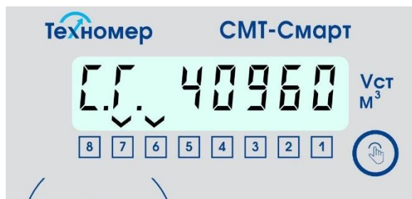
Рисунок 33 – индикация раздела «Состав газа» (К-фактор=40960-воздух)
