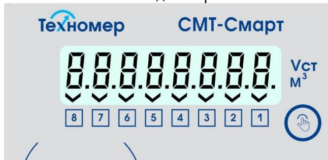
Рисунок 52 – Индикация раздела «Тест индикатора»
