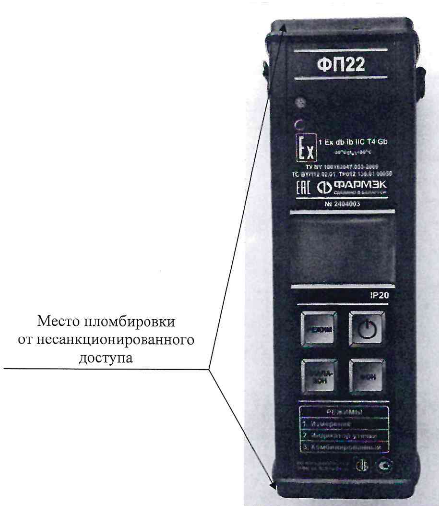
Рисунок 3.1 – Схема пломбировки от несанкционированного доступа
