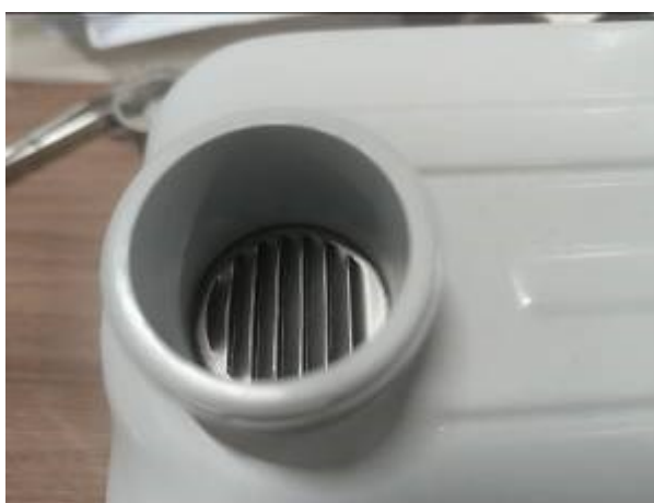
Рисунок 2 – Общий вид патрубка счетчика с дополнительной вставкой
