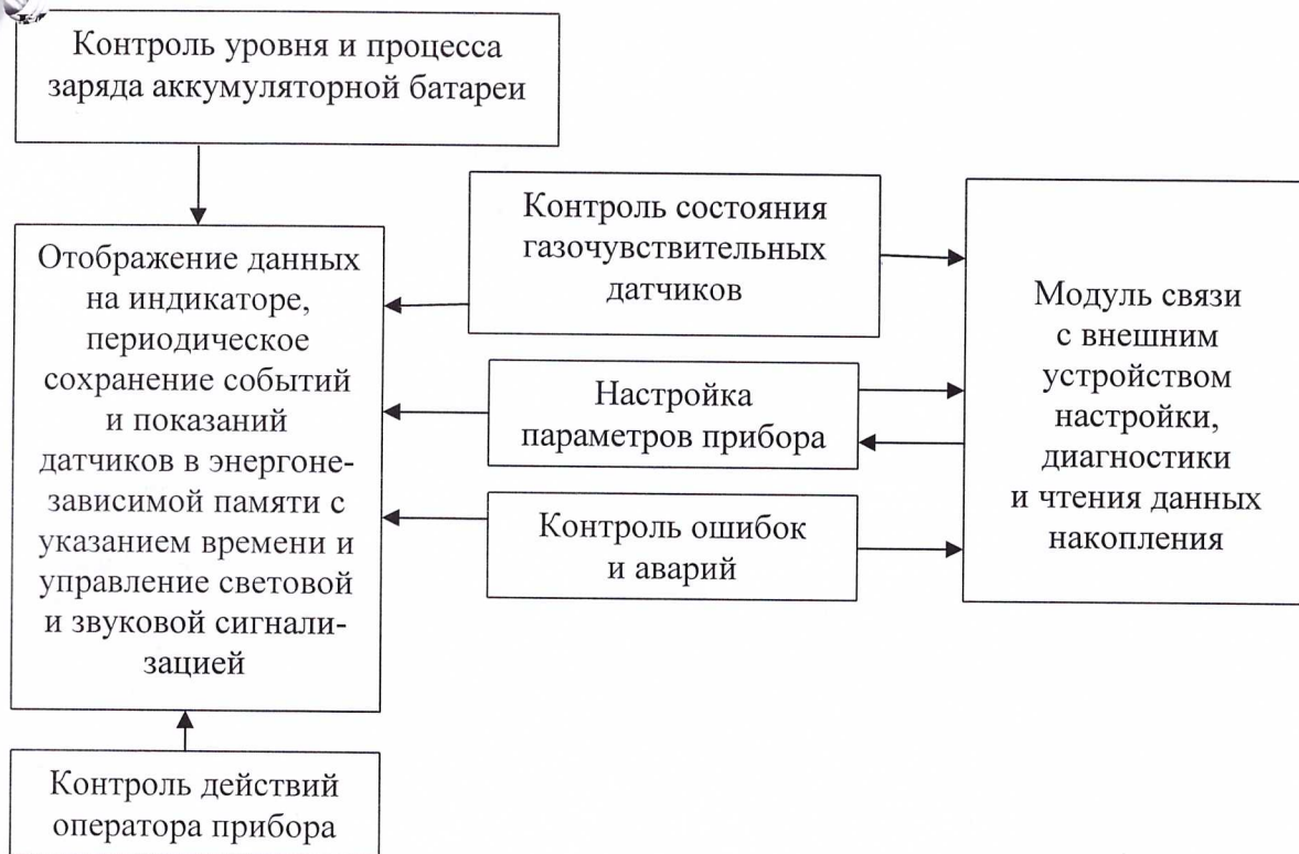
Рисунок 3 - Структура ПО газоанализатора ФПЗЗ
