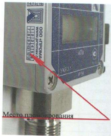
Рисунок 2 - Места пломбирования датчиков
