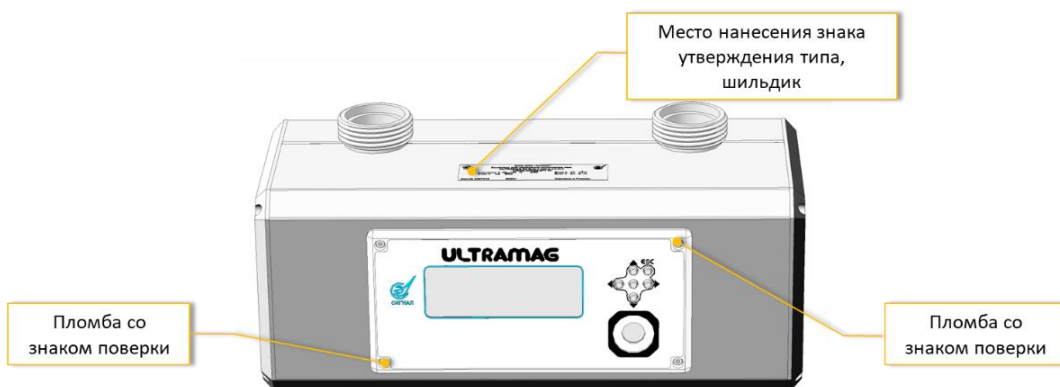
Рисунок 6 – Схема пломбировки комплекса варианта исполнения V, указание места нанесения знака утверждения типа, расположение шильдика
