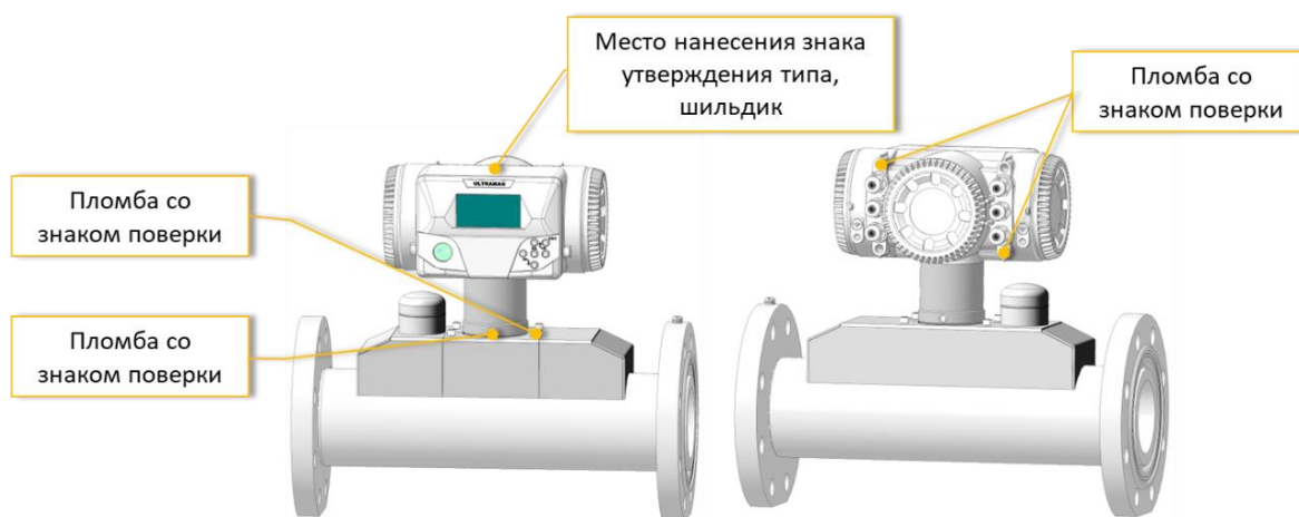
Рисунок 5 – Схема пломбировки комплекса с фланцевым присоединением (модернизированный ИВБ), указание места нанесения знака утверждения типа, расположение шильдика
