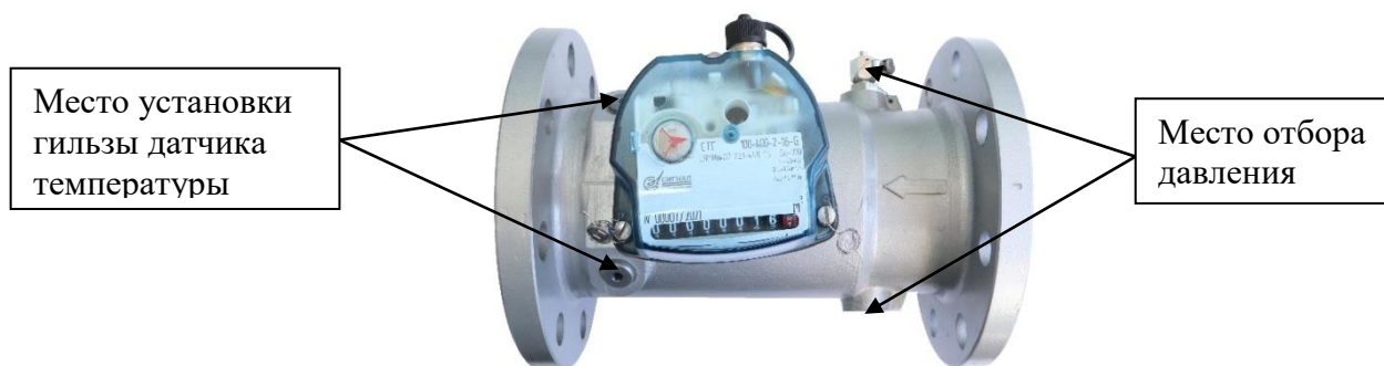
Места отбора давления и установки защитной гильзы датчика температуры Исполнения Silver
