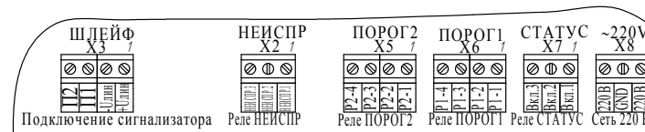
А Обозначение групп клеммных колодок и назначение их контактов
