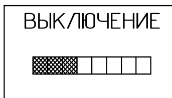
Рисунок 2.4 – Вид графического дисплея при выключении индикатора
