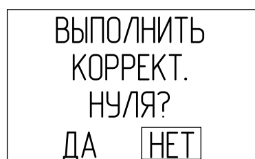
Рисунок 3.3 – Меню корректировки нулевых показаний
