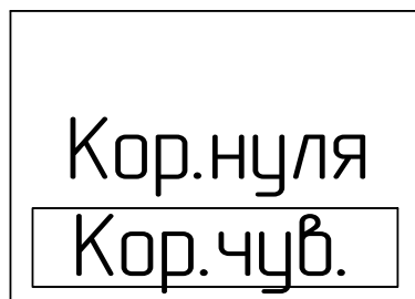
Рисунок 3.4 – Вид табло индикатора в режиме корректировки чувствительности
