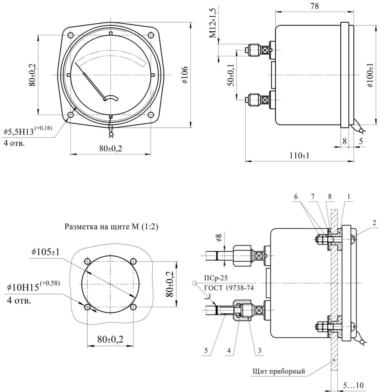
1 – втулка; 2 – винт М5×32; 3 – гайка; 4 – прокладка; 5 – ниппель;
