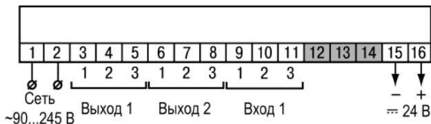
Рисунок 5.2 – Назначение контактов клеммной колодки прибора в настенном Н и щитовом Щ1, Щ2 типах корпусов
