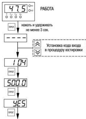
Рисунок 8.2 – Последовательность работы при юстировке
