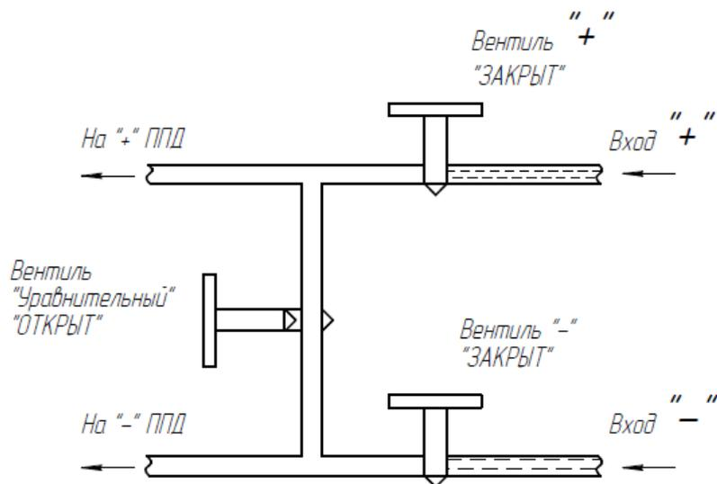
После запуска счетчика газа (действия по п.п.1...3) и выхода его на рабочий режим эксплуатации произвести запуск преобразователя перепада давления в следующей последовательности:
