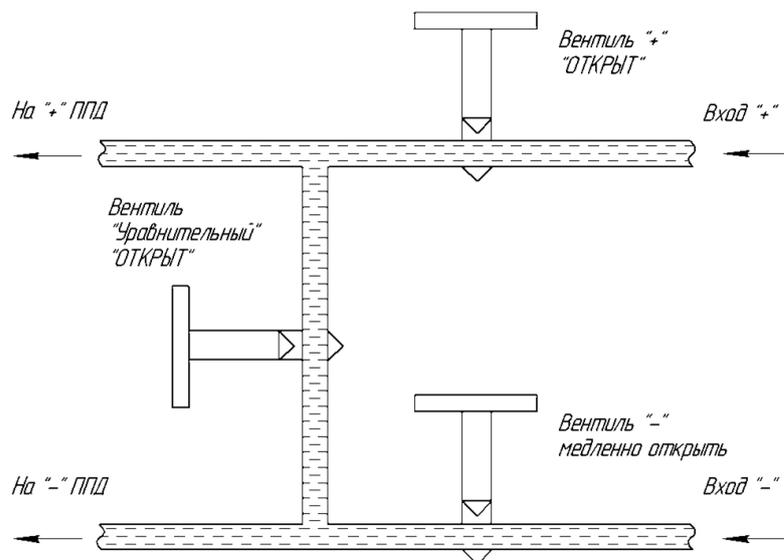
После опрессовки (сброса испытательного давления) закрыть сначала вентиль минусовой камеры, затем вентиль плюсовой камеры, уравнивательный вентиль оставить открытым.
