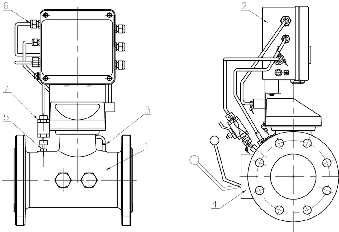
1 - Счетчик газа турбинный РГ-Т
