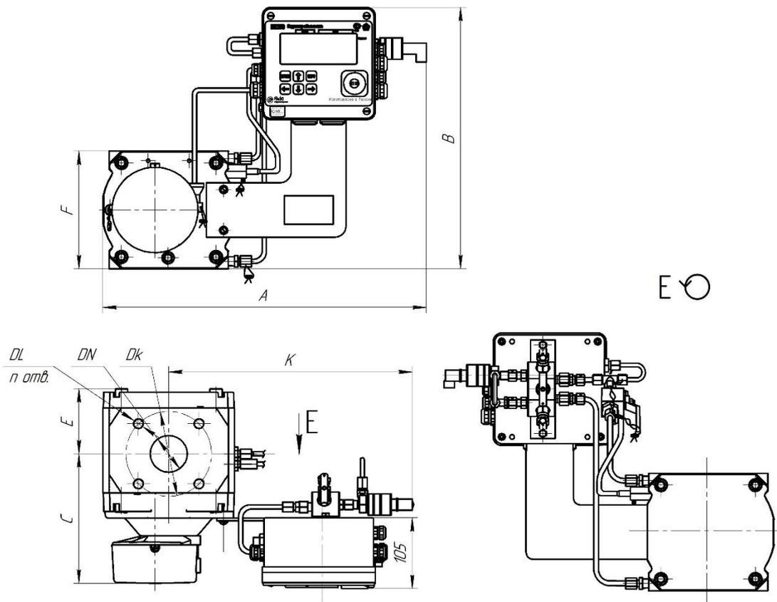
Рисунок 5 Направление потока газа: сверху – вниз
