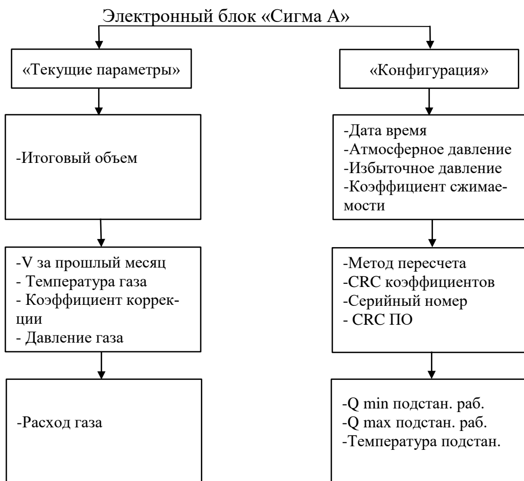
Рисунок 7 – Схема отображения информации на дисплее счетчика.
