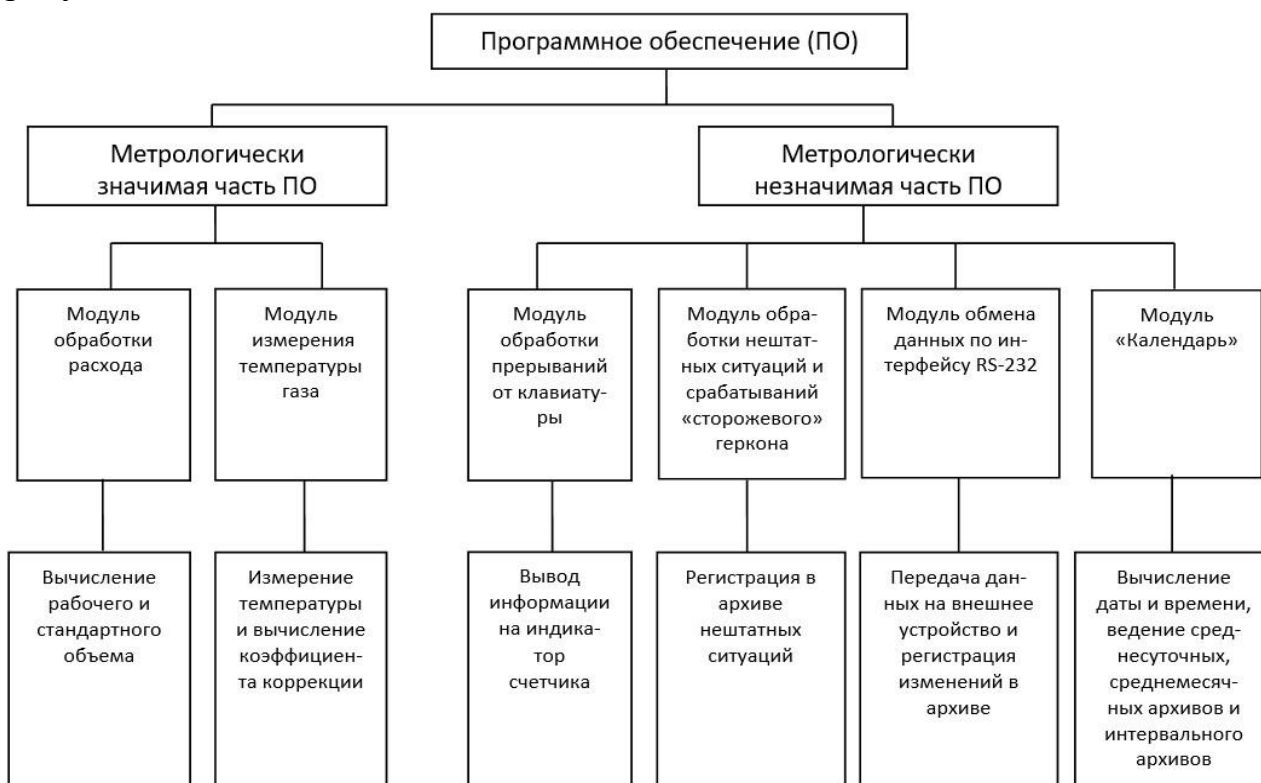
Рисунок 4 – Структура программного обеспечения счетчика
