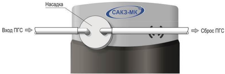
Рисунок Ж.1 – Схема установки насадки
