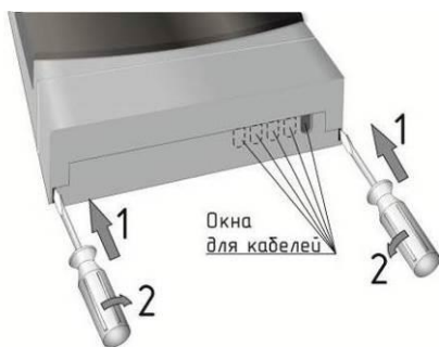
Рисунок 4 – Снятие крышки клеммного отсека
