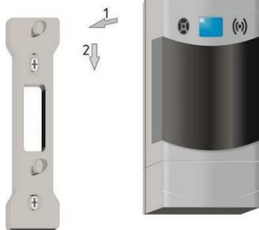
Рисунок 5 – Установка сигнализатора на монтажную панель
