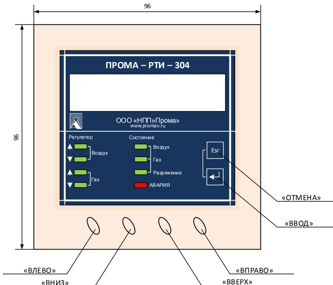
Прибор управляется при помощи шести кнопок на передней панели. Внизу панели расположены кнопки ВЛЕВО, ВНИЗ, ВВЕРХ, ВПРАВО. Выше вертикально располагаются ещё две кнопки: ESC и ВВОД.
