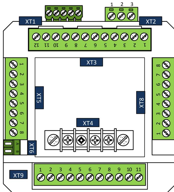
**клеммник XT1** – обеспечит напряжением +24В для подключения аналоговых датчиков давления;
