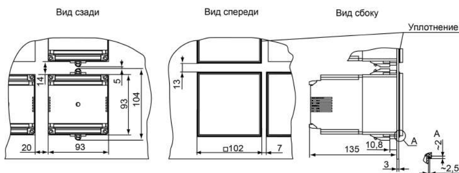
Рисунок 4.3 – Прибор в корпусе Щ4, установленный в щит толщиной 3 мм
