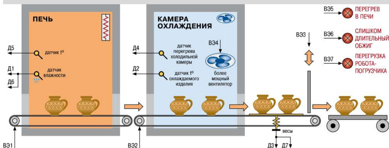
Рисунок 7.4 – Использование 8-канального регулятора ТРМ148 2-ой модификации в автоматизированном процессе обжига глиняных изделий
