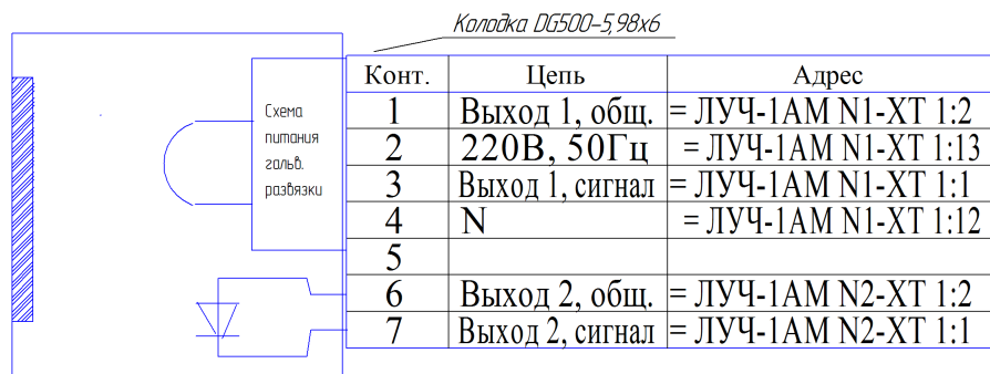
Рис.8. Выходные электрические цепи фотодатчика ФД-05ГМ.
