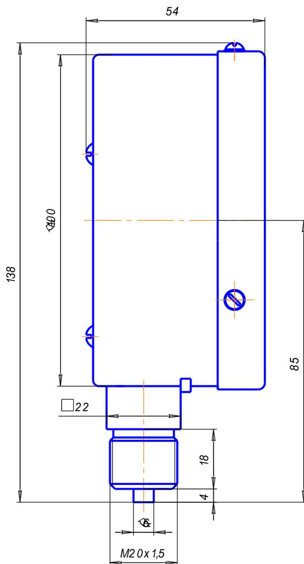
Рисунок 6 – Габаритные и присоединительные размеры прибора с радиальным расположением штуцера
