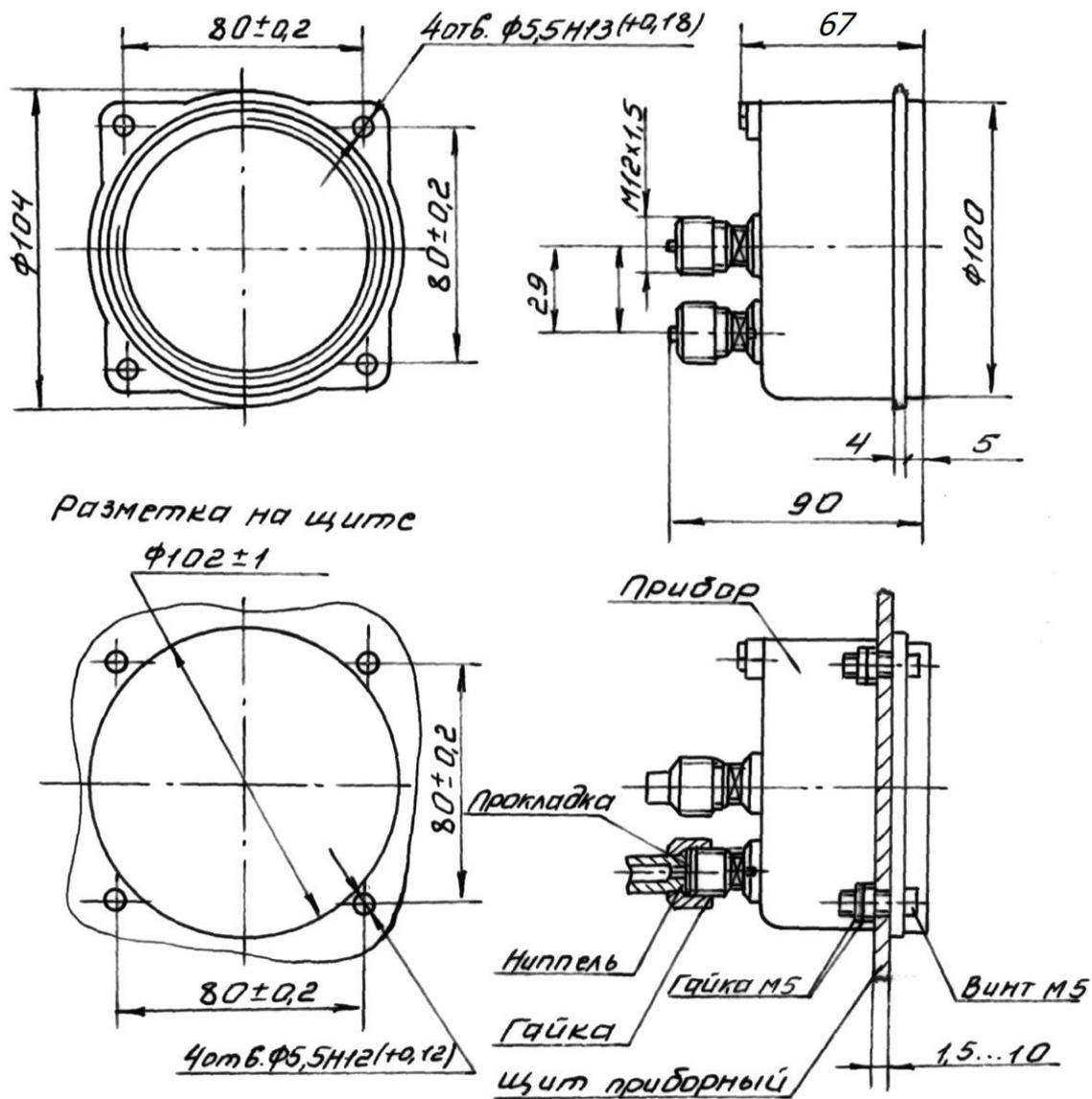
Рисунок 5 – Габаритные и присоединительные размеры прибора (для коррозионно-стойкого исполнения «Астр»)
