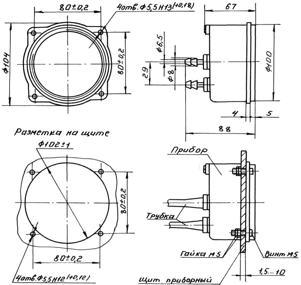
Рисунок 4 – Габаритные и присоединительные размеры прибора
