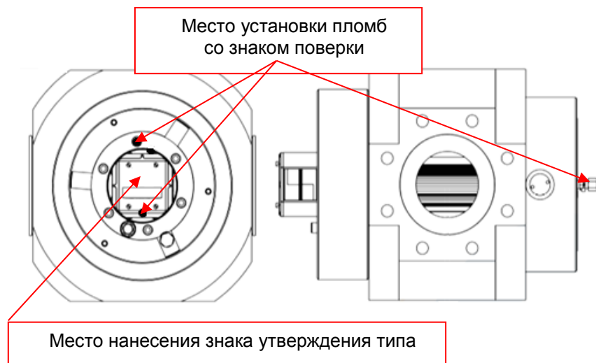
Рисунок Е5 – Схема установки пломб со знаком поверки и места нанесения знака утверждения типа на счетчики исполнения Gray до 10,0 МПа.
