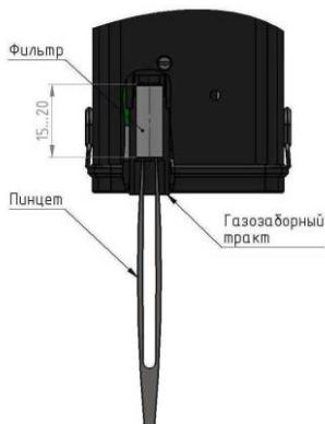
Перевернуть прибор газозаборным трактом вниз и пинцетом извлечь фильтр. После извлечения фильтра следует очистить газозаборный тракт и вставить новый сигаретный фильтр.
