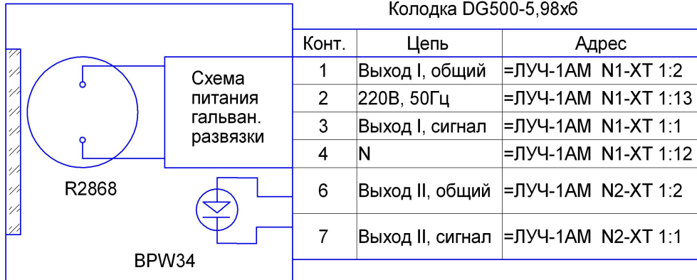
Рис.1. Фотодатчик ФД-05 ГМ. Схема электрическая принципиальная.
