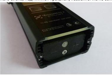
(Конструкция ФП 22ранней версии требовала полной разборки прибора для замены аккумуляторов или сенсоров, а так же новую калибровку прибора в случае замены сенсоров).
