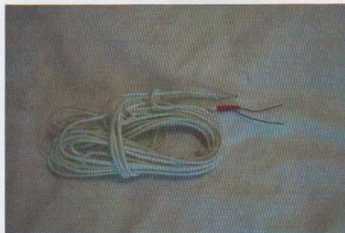
Рисунок 1 - Общий вид бескорпусных ДТП модификации ХХ1
